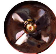
Stauscheibe mit Standard-Heizöl
