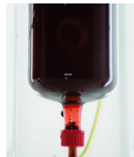
Standard-Heizöl in gealtertem Zustand
