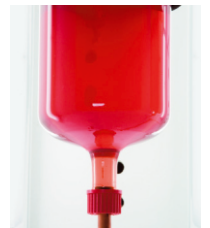
PremiumHeizöl ecotherm in gealtertem Zustand
